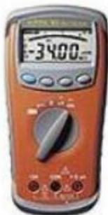
U пост.0,1 мВ-1000 В, U пер.1 мВ-750 В (40 Гц-500 Гц), I пост./пер. 0,1 мкА-10А (40 Гц-500 Гц), сопр 0,1 Ом-30 МОм, прозвон, испытание р-п, базовая погрешность 0,5 %, 4 разряда (3400), линейная шкада, питание 1,5 Вx2,чехол масса 490 г
