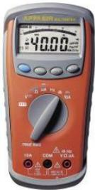
U пост.0,1 мВ-1000 В, U пер.0,1 мВ-750 В (40 Гц-500 Гц), I пост./пер.0,1 мкА-10 А (40 Гц-500 Гц), сопр.0,1 Ом-40 МОм, F 1 Гц-40 МГц, C-1 пФ...40 мФ, прозвон, испытание р-п, базовая погрешность 0,5 %, , 4 разряда, (4000), питание 9 В(крона). True RMS, чехол масса 490 г
