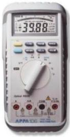
U пост.0,1 мВ - 1000 В, U пер.0,1 мВ-750 В, I постпер.10 мкА- 10 А, сопр. 0,1 Ом-40 МОм, F 1 Гц-400 МГц, C 1 пФ-40 мФ, изм. Температуры -20+800 °С, минмакс показания, относ. измерения, подсветка шкалы, RS-232 интерфейс, масса 620 г
