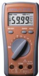
Базовая погрешность 0,5 %, U пост. 0,1 мВ-1000 В, U пер. 1 мВ-750 В (50 Гц-500 Гц True RMS), I пост. 0,1 мкА-10 А, пер. 0,01 мА-10 А (50 Гц-500 Гц True RMS), сопр 0,1 Ом-60 МОм, F 1Гц...60 МГц, С 1 пФ...6 мФ, прозвон, испытание р-н, 4 разряда (6000), питание 9 В, оптоизолиров. RS-232, опция кабель IC-70 (RS-232 или USB), масса 350 г
