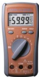
Базовая погрешность 0,5 %, U пост. 0,1 мВ-1000 В, U пер. 1 мВ-750 В (50 Гц-500 Гц True RMS), I пост. 0,1 мкА-10 А, пер. 0,01 мА-10 А (50 Гц-500 Гц True RMS), сопр 0,1 Ом-60 МОм, F 1Гц...60 МГц С 1пФ...6мФ, прозвон, испытание р-н, 4 разряда (6000), питание 9 В, масса 350 г
