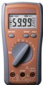
U пост. 0,4...1000В (погрешность  $\pm 0,5\%$  (базовая)), U пер. 0,4...750 В (50 Гц-500 Гц), I пост 0,1...4000 мкА, R 0,1 Ом...40 МОм (разрешение 0,1 Ом), емкость 4 нФ...4 мФ (1 пФ), прозвон цепи (до 30 Ом) и проверка диодов, частота 4 кГц-40 МГц, удержание параметров, удержание пиковых значений, мин/макс, REL измерения, графическая линейная шкала, дисплей 4 разряда (4000), питание 2 X1,5 В, автоотключение, противоударное исполнение (до 1,2 м), масса 350 г.
