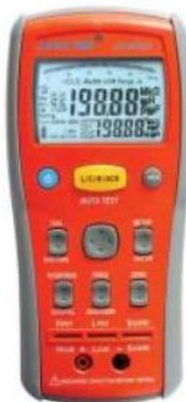
Измеритель RLC портативный: автовыбор режима L/ C/ R: 20/ 200 Ом/ 2/ 20/ 200 кОм/ 2/ 20/ 200 МОм (Rdc); 2/ 20/ 200 нФ/ 2/ 20/ 200 мкФ/ 20 мФ; 2/ 20/ 200 мГн/ 2/ 20/ 200 Гн/ 2/ 20 кГн; Q/D/ЭПС, базовая погрешность  $\pm 0,2\%$ , тест-сигнал 100, 120 Гц, 1 кГц и фиксированный уровень 600 мВскз, скорость измерений 1,25 изм/с., компенсация ХХ и КЗ, абс. значение, относит. измерения, USB, индик. 5 разрядов, 4×1,5 В (AA), изм. кабель «банан-крокодил» (2), масса 600 г
